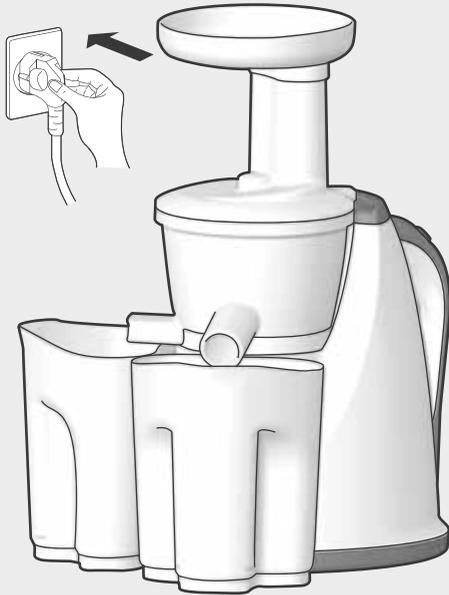
Montieren Sie das ganze Set auf den Rumpf. Nun verbinden Sie das Netzkabel mit einer Steckdose. Stellen Sie jeweils ein Gefäß unter den Tresterauswurf und eines unter den Saftauslass.
